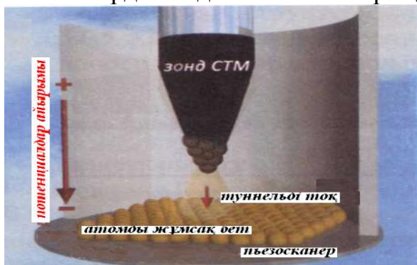
а – сканирлеуші туннельді микроскоп қондырғысы
